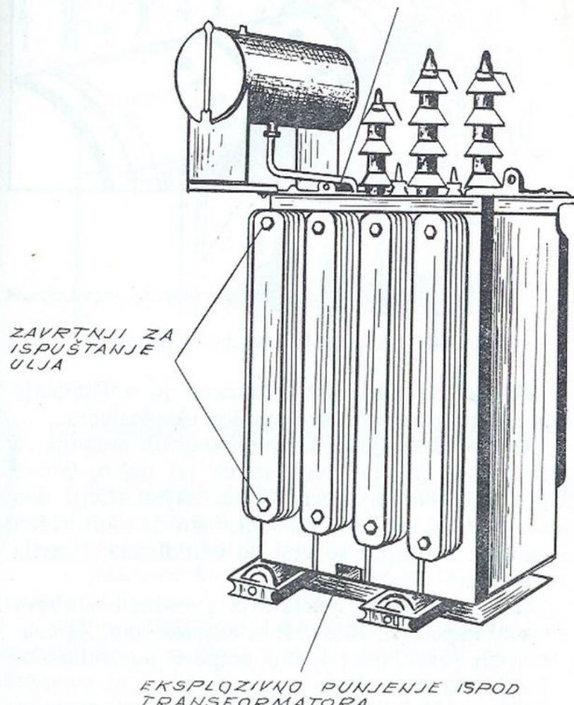
Sl. 148. Uništavanje uljanog transformatora eksplozivom
